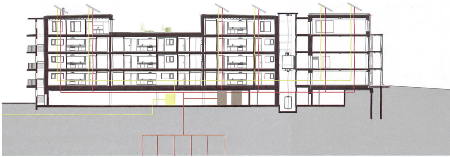
Hybridkollektoren auf dem Dach erzeugen Strom und warmes Wasser. Überschüssige Wärme wird mittels Erdsonden im Erdreich gespeichert und bei Bedarf abgeholt.
