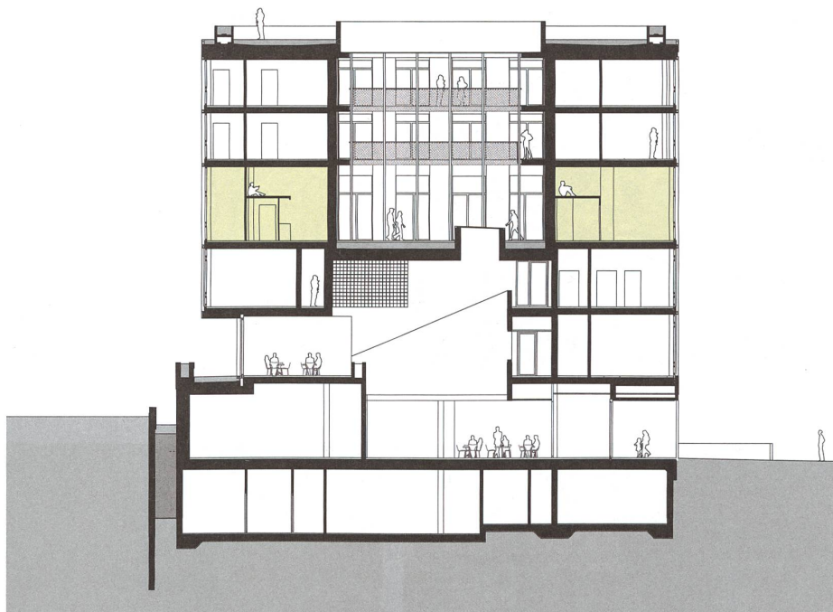
Zollhaus-Kopfbau im Querschnitt: Das Hallenwohnen (grün) umschliesst das Atrium im dritten Obergeschoss. Darunter öffnet sich das Forum links zur Gleisterrasse und, eine Etage tiefer, rechts zur Zoll-/Langstrasse.
