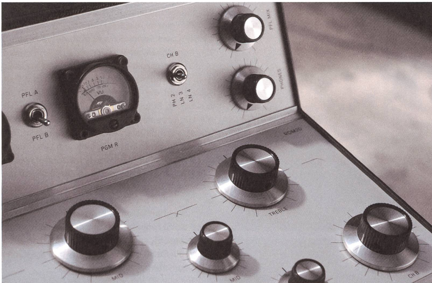
Der DJ bedient ein Rotary-Mischpult mit Drehreglern, den Potis.
