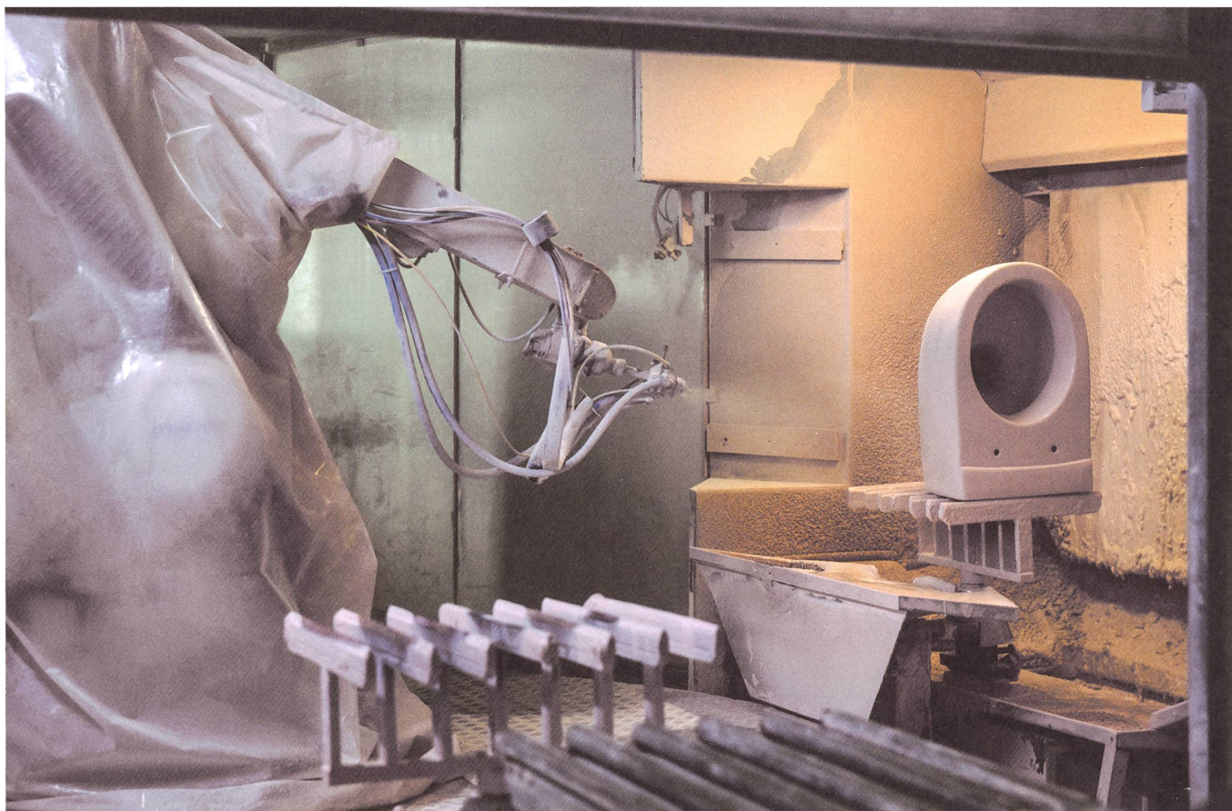
Die Glasur wird maschinell aufgetragen.
