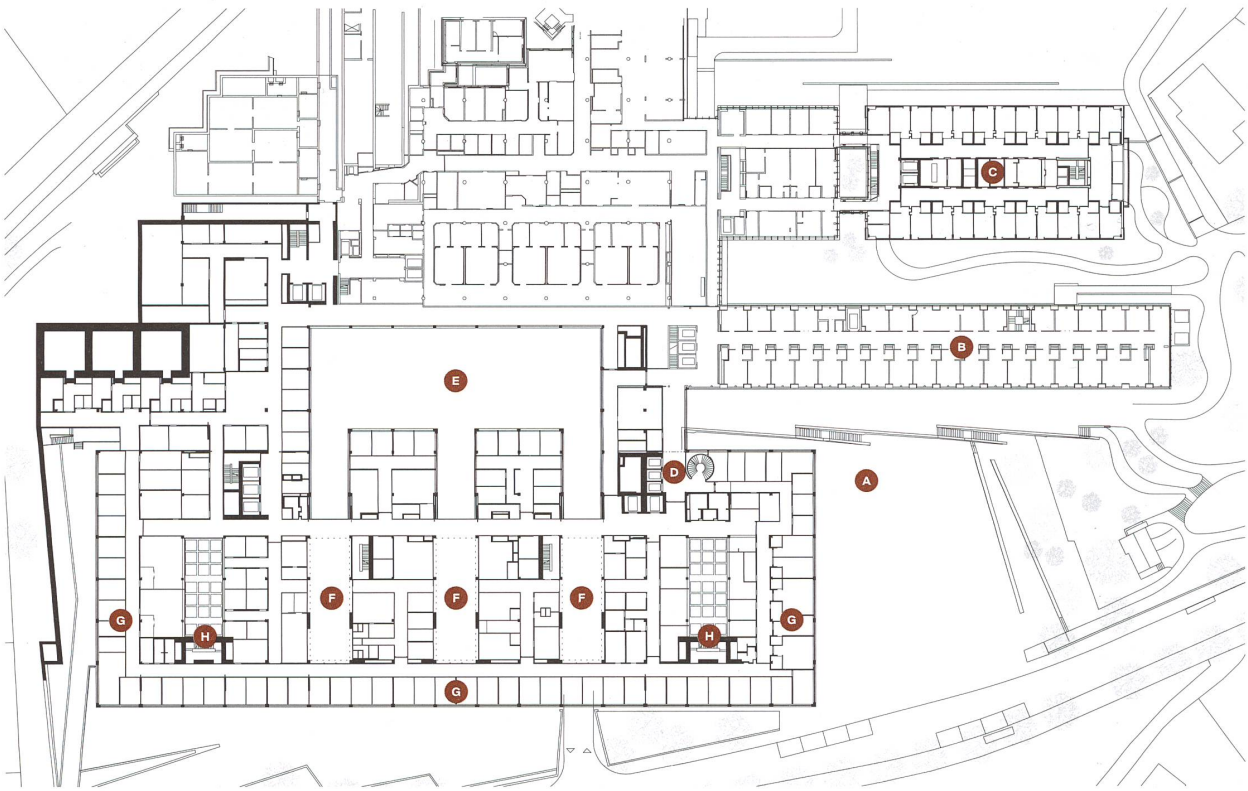
11 Zweites Obergeschoss. A Spitalpark, B Bettenhaus, Gmür Vacchini, 2000, C Kinderklinik, Stauer & Hasler, 2019, D Haupttreppenhaus, E Innenhof, F Innenhalle, dreigeschossig, G Untersuchungs- und Behandlungsräume, H Lichthof.
