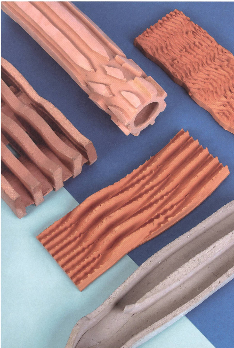
Dank Körperkraft und unkonventionellen Düsen entstehen im Extrusionsverfahren neuartige Tonstrukturen.
