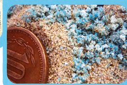
La plage de dunes de Chañaral (grande photo) a l'air magnifique. Elle est toutefois constituée de déchets provenant d'une mine de cuivre (à gauche). Le chlorure de cuivre colore le sable en vert en de nombreux endroits (ci-dessous).
