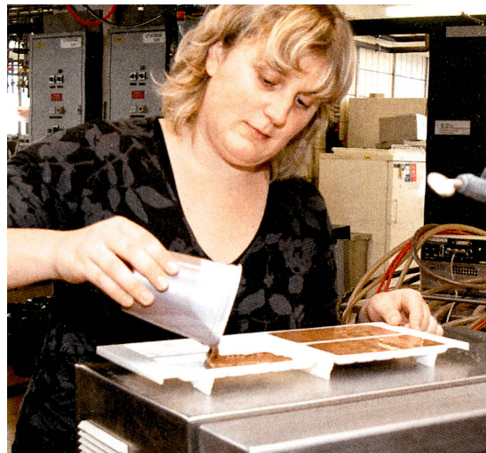
La précristallisation (en bas à gauche) est une étape décisive. Elle est responsable de la consistance et de l'onctuosité du chocolat. Celui-ci est ensuite conditionné en tablettes qui sont entreposées à une température de 18 degrés (en haut).
