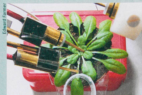
Les électrodes mesurent les signaux électriques de l'arabette des dames.
