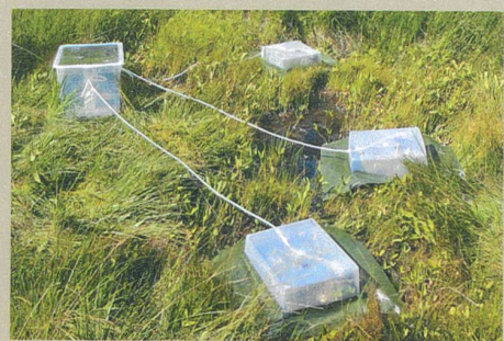
Pièges à métaux lourds installés dans le cadre d'une expérience au Tessin.
