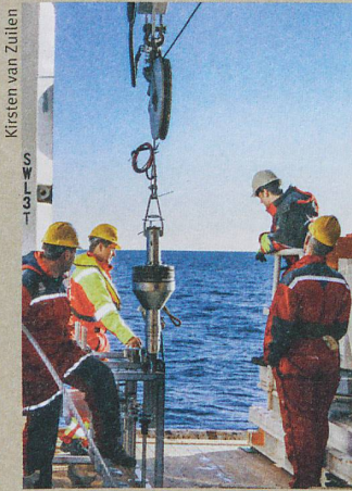
Embarqué sur le navire de recherche G.O. Sars, ce tube prélève des échantillons du fonds marin.
