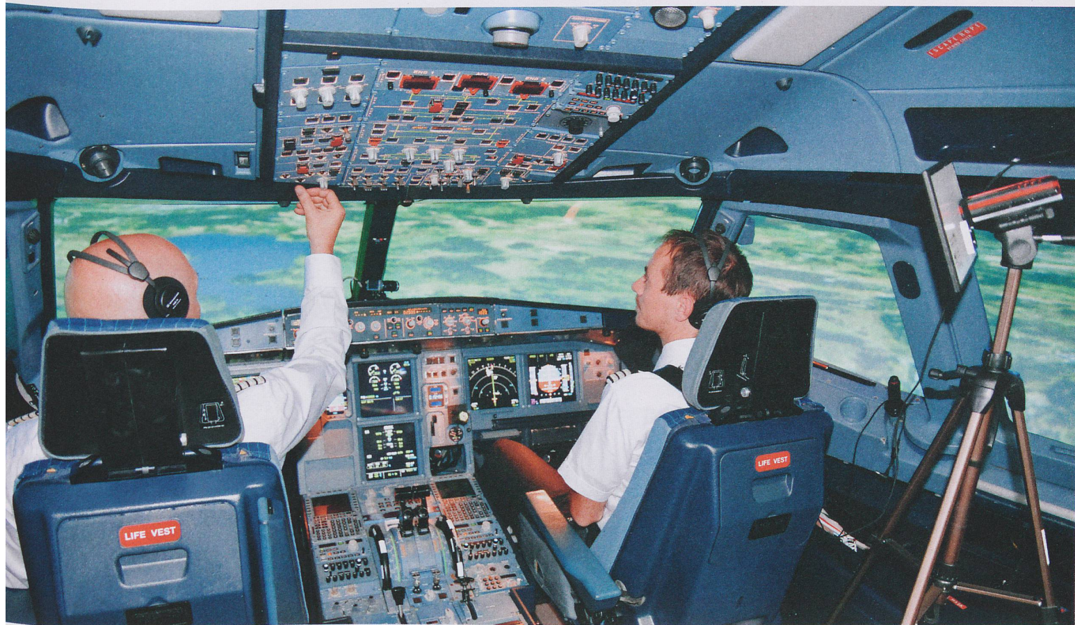
Installées dans le cockpit du simulateur de vol, quatre caméras aidées par des flashes infrarouges permettent de déterminer la direction du regard des pilotes. Photo: David Rudi
