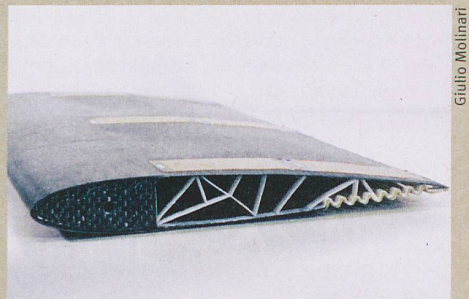
L'aile déformable de l'ETH Zurich agit comme un aileron avec une résistance de l'air réduite.
