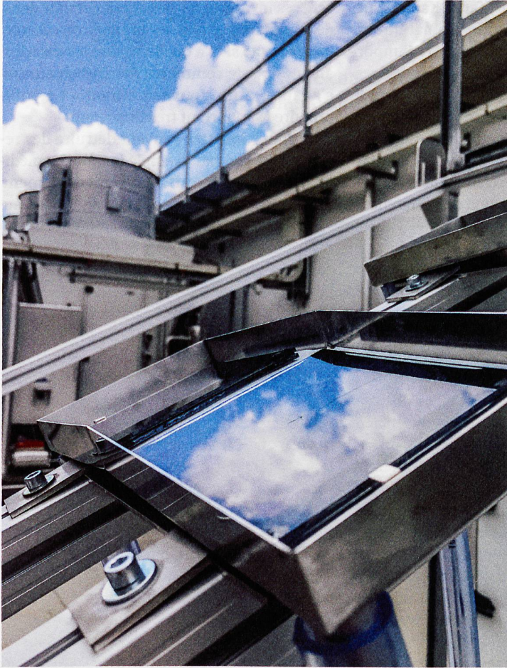
Sur le toit à Muttenz, on teste si du plomb issu des cellules photovoltaïques en pérovskite peut finir dans les eaux pluviales. Photo: mäd
