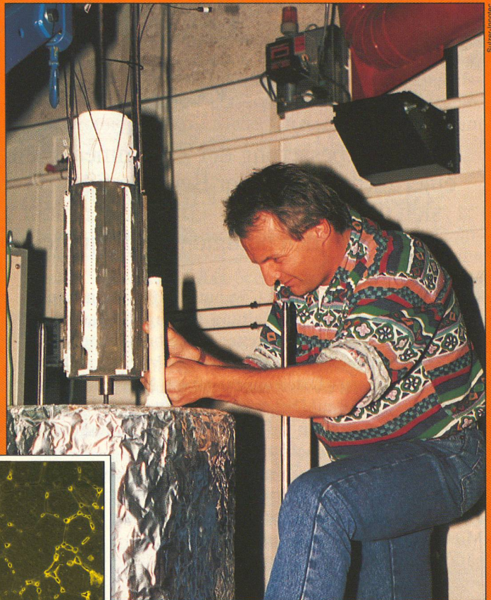
Oben: 50 Scheiben bauen diesen Prototyp einer Brennstoffzelle von 1000 Watt Leistung auf.
