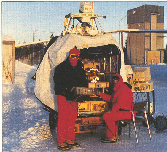
Bei -28°C wird in nordschwedischen Kiruna die Instrumentengondel eines Ballons zur Stratosphärenfahrt vorbereitet.
