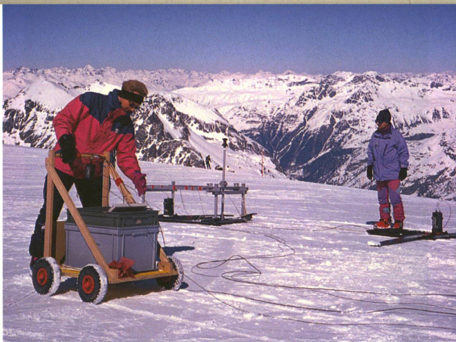
Versuche auf dem Eis: Forscher der ETH Zürich erproben ein mobiles Georadargerät für die Untersuchung bodennaher Schichten.
