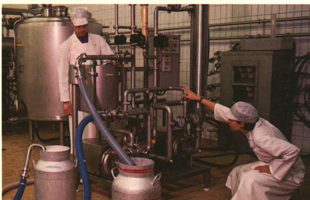
In der Mikrofilteranlage gibt es für die fatalen Bakteriensporen kein Durchkommen mehr. Der Filter hält aber auch Willkommenes ab.
