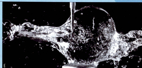
Bei der Kavitation bilden sich durch Druckveränderungen Blasen, die implodieren. Dies verstärkt z.B. die Erosion von Wasserturbinen und Schiffspropellern (links). Die Schwarzweissbilder zeigen die Kavitation in der Schwerelosigkeit: Flüssigkeit in Kugelform; darin implodiert eine Blase (ganz oben), und es entstehen zwei Strahlen (oben).
