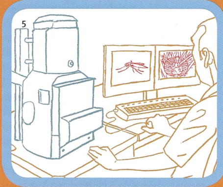
Abb. 4 In der Objektkammer des REM: An jedem Punkt, wo der Primärelektronenstrahl auf die Mücke trifft, werden aus den obersten Schichten der Mücke so genannte Sekundärelektronen (SE) ausgeschleudert. Über einen seitlich angebrachten Detektor (D) werden die herausgeschleuderten Elektronen erfasst und je nach Anzahl in einen bestimmten Grauwert übersetzt. Dieses optische Signal wird verstärkt und in Form eines elektrischen Signals an einen Monitor oder Computer weitergeleitet. Je nachdem, welche Ausrichtung der gerade abgetastete Teil der Mücke zum Detektor hat, kann der Detektor mehr oder weniger Elektronen auffangen, was entsprechend hellere oder dunklere Grautöne ergibt. Durch die seitliche Position des Detektors entstehen räumlich wirkende Bilder, die aussehen, als wären sie aus der Richtung des Elektronenstrahls aufgenommen und vom Detektor aus seitlich beleuchtet.
