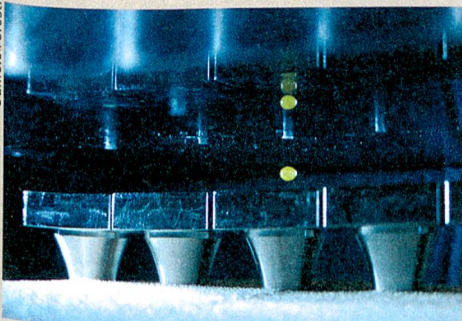
Kontaktlose Reaktionen: Die Akustophorese verstärkt die fluoreszierende Emission einer Chemikalie (grün).
