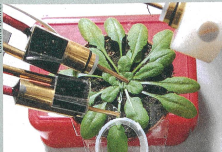
Unter Strom: Die Elektroden messen die elektrischen Aktivitäten der Acker-Schmalwand.
