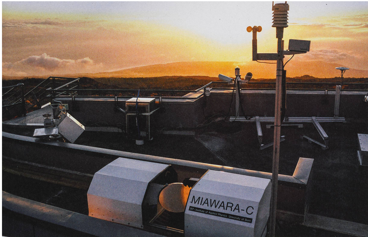
Feuchte Luft über der Insel La Réunion: Das Mikrowellen-Radiometer des Instituts für Angewandte Physik der Universität Bern misst den Wasserdampfgehalt der Atmosphäre über dem Indischen Ozean. Die gleiche Technik kommt in der Schweiz zum Einsatz. Bild: Niklaus Kämpfer
