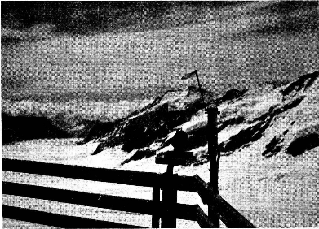
Sonnenscheinautograph u. Solarimeter mit Schirm zum Ablenden der Sonne.
