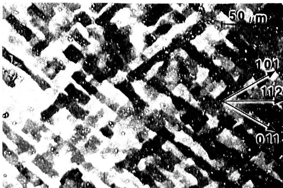
Figure 5 Sous-grains de fluage. Monocristal d'aluminium d'axe 112. Section (\bar{1}\bar{1}1) , 150^\circ\text{C} , 19,6 \text{ MPa} , \epsilon = 20\% . Microscope à balayage. Electrons rétrodiffusés. D'après [14].
