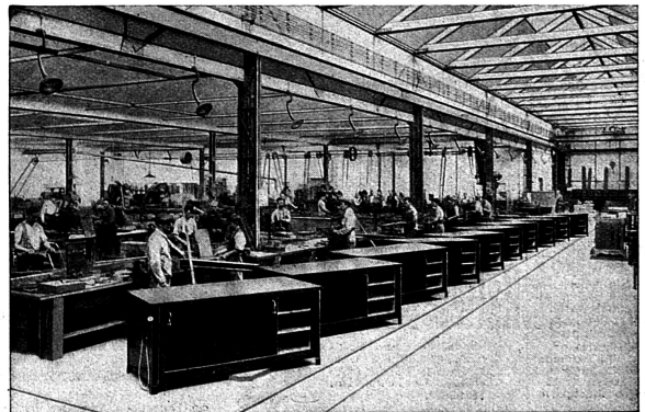
Zehn emaillierte Wärmeschränke à 2 Meter Länge in unserer Montagehalle für Gasgrossapparate.
