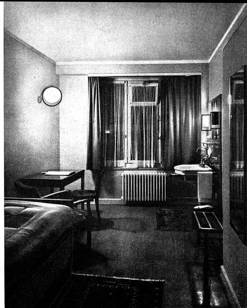
Bild 12. Einzelzimmer. Bei den in der Regel kleinen Einzelzimmern kann auf eine Deckenleuchte zugunsten der besseren Beleuchtung des Arbeitstisches verzichtet werden. Einwandfreie Spiegelbeleuchtung durch Metalleuchten mit Opal-Glasabdeckung gegen die Spiegelfläche.
