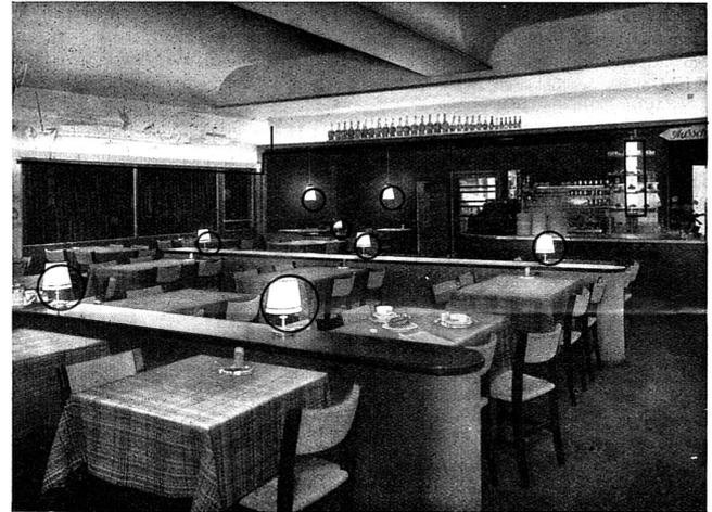
Bild 7. Restaurant. Die indirekte Allgemein-Beleuchtung erfolgt von den Hohlräumen aus, die den Wänden entlang angebracht sind. Zusätzliche Beleuchtung durch Stehlampen. Die durchleuchtete Opalglastüte rückt Früchte usw. ins richtige Licht.
