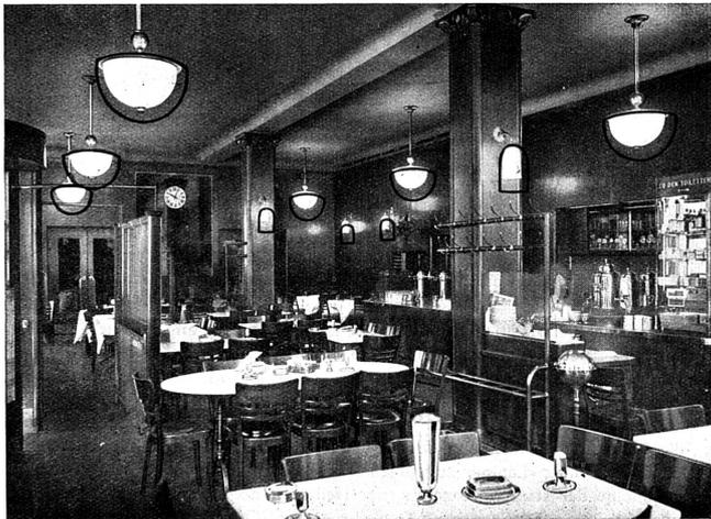
Bild 4. Restaurant. Das dunkle Holz verlangt eine reichliche Beleuchtung, die durch grossflächige Pendelleuchten und ergänzende Wandarme erreicht wird.
