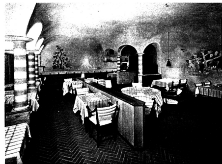
Locanda Ticinese im Hotel Monte Verità in Ascona. Fussboden in Zürcher Tonplatten mit grauer Ausfugung, Wände und Gewölbe mit verschiedenfarbigem Putz durch den Architekten selbst aufgetragen, Polsterbezüge blau und weiss, Tischtücher leinen bedruckt.
