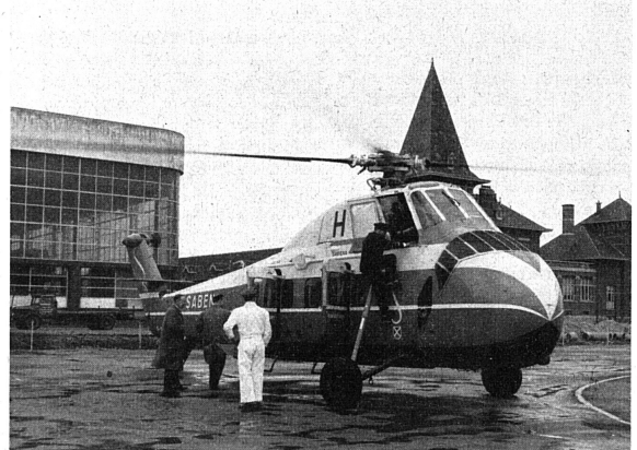
Un Sikorsky S-58, de la compagnie belge Sabena, prêt au départ. Au sommet de l'appareil, sous le rotor principal, le poste de pilotage. En bas, la cabine, divisée en deux compartiments, auxquels les douze passagers accèdent par deux portes séparées.
