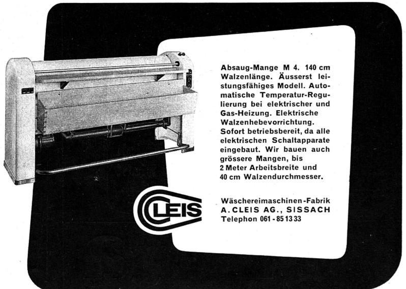
Absaug-Mänge M 4. 140 cm Walzenlänge. Äusserst leistungsfähiges Modell. Automatische Temperatur-Regulierung bei elektrischer und Gas-Heizung. Elektrische Walzenhebevorrichtung. Sofort betriebsbereit, da alle elektrischen Schaltapparate eingebaut. Wir bauen auch grössere Mangen, bis 2 Meter Arbeitsbreite und 40 cm Walzendurchmesser.
