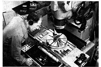
Yverdon: Elektronische Hörkontrolle des Schließens eines Typenhebelgesenkes.
