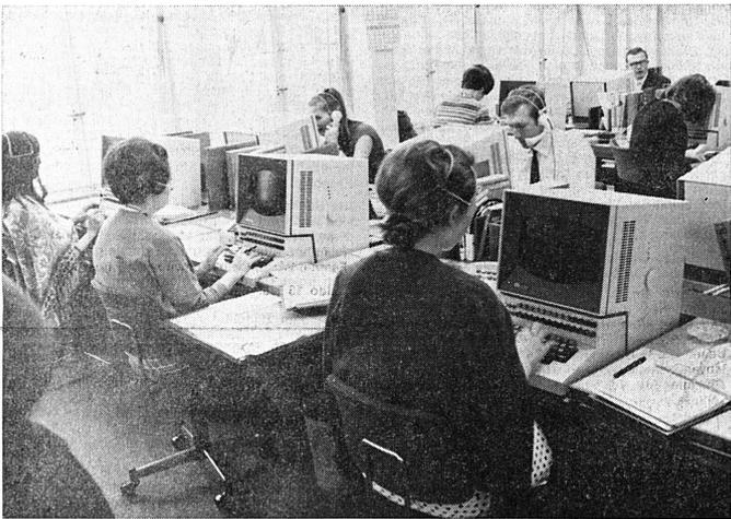
Chez Swissair, les ordres de réservation adressés téléphoniquement au bureau de réservation à Zurich, sont enregistrés directement par l'intermédiaire d'écrans cathodiques dans un système électronique de réservation contrôlé par un ordinateur. 42 écrans cathodiques sont à la disposition d'agents de réservation qui reçoivent et traitent quotidiennement jusqu'à 2500 ordres de réservation adressés téléphoniquement entre 06.30 h. et 22.30 h.
