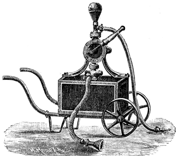
Fig. 7 (Die Flügelpumpe als Feuerspritze).
