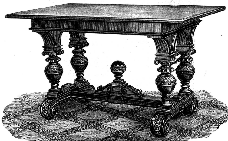
Geschmückter Speisetisch. Entworfen von C. Arnold, Schreinermeister. Ausführung in Eichen- oder Nussbaumholz. Größe der Tischplatte 125 Cm. auf 80 Cm. Durch 2 aufzuklappende Einlagen unter der Tischplatte kann die Länge des Tisches verdoppelt werden.
