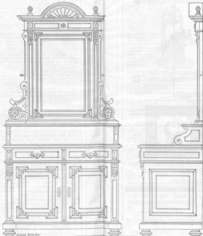
Nach eigenem Entwurf ausgeführt von Schreinermeister Sauer & Schloßer in Altstätten. Diplomirt an der Landesausstellung in Zürich. c) Maßstäblich mit Spiegelansicht (Rücken- und Seitenansicht). — Maßstab 1:10. (Siehe Beiblatt-Zeichnung in Nr. 47 d. Bl.)
