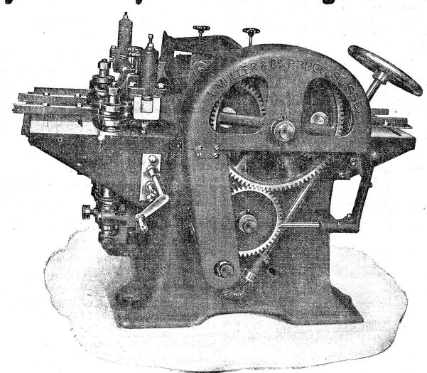
Ncuste modernste Konstruktionen, mit 2861 d Ringschmierung, automatisch gefrästen Triebmatern, geschliffenen Wellen etc.
