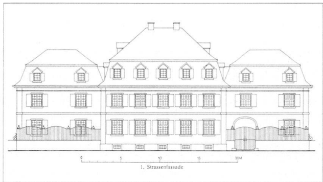
Abb. 47–49 Liestal. Heimatschutz und Heimatstil in der Tätigkeit von Architekt Wilhelm (II.) Brodtbeck (1873–1957). Das Untere Spital, erb. 1766–1769 (vgl. Abb. 39, 40). Kommentar von W. Brodtbeck: «In den Proportionen, der Dachgestaltung wie in der Gesamtanlage ein typisches Beispiel der alten Bauweise im Baselbiet. Die Grundformen finden sich, modern umgestaltet, im folgenden Neubau wieder». – Anstalt Schillingsrain, erbaut 1908–1909 von W. Brodtbeck, von ihm kommentiert: «Die innere Anlage spricht sich im Aufriss deutlich aus. Beachtenswert die wichtige Rolle des Daches, in dekorativer und praktischer Beziehung. Vgl. vorhergehende Abbildung als anregendes altes Beispiel». – Berri-Gut, erb. um 1768 (vgl. Abb. 20, 36), Aufriss von W. Brodtbeck. – Photo oben und Zitate aus der Zeitschrift Heimatschutz 8 (1913), S. 42–43. Photo Mitte um 1920. Plan aus Das Bürgerhaus im Kanton Basel-Landschaft , Text von Karl Gauss, Bauaufnahmen von Wilhelm Brodtbeck und Fritz Bohny, Zürich 1931.
