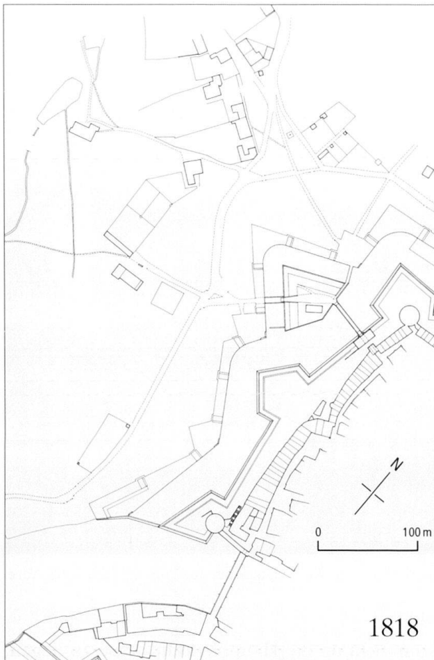
Abb.24–25 Bauliche Entwicklung im Westringquartier. Neu hinzugekommene Bauten sind schwarz eingezeichnet. Rekonstruktionszeichnungen von Markus Hochstrasser. – 1818 Situation mit barockem Schanzengürtel und Vorwerken. – 1856 Abbruch der Vorwerke und Bau der Biel- und der Werkhofstrasse.
