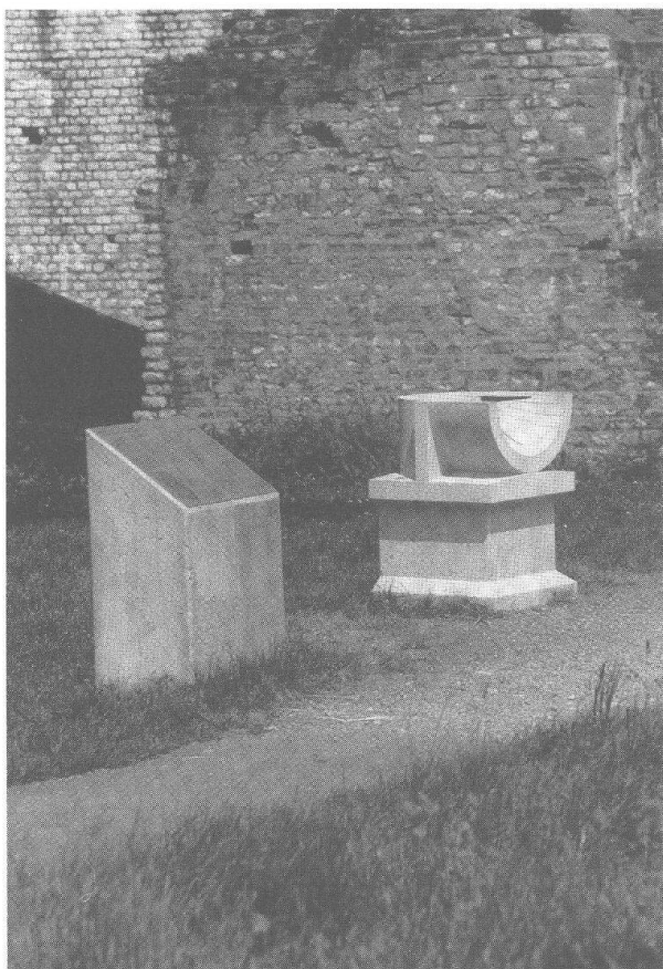
Abb. 1 In Jurakalkstein rekonstruierte römische Sonnenuhr auf dem Gelände von Augusta Raurica, nach einem Original aus Grenoble. Die Aufteilung der vertikalen Stundenlinien und der horizontalen Sonnwendlinien erfolgte empirisch in Augst vor Ort während eines Beobachtungs-Halbjahres.
