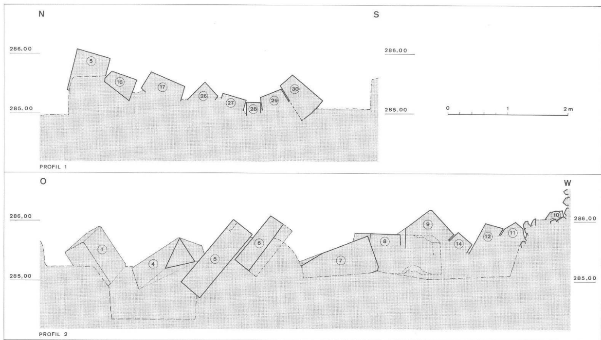
Abb. 7 Augst-«Bötme» (Grabung 1969.52). Violenbachbrücke. Profil 1 (oben) und Profil 2 (unten). M. 1:60. Die Schnittzeichnungen illustrieren die bogenförmige Versturzlage der Quader. Die Zahlen beziehen sich auf die Quadernummern in Abb. 4 (vgl. dort auch die Lage der Profile). Da die Schnittebene schräg durch die Steine geht, ist eine zeichnerische Ergänzung nicht sinnvoll.
