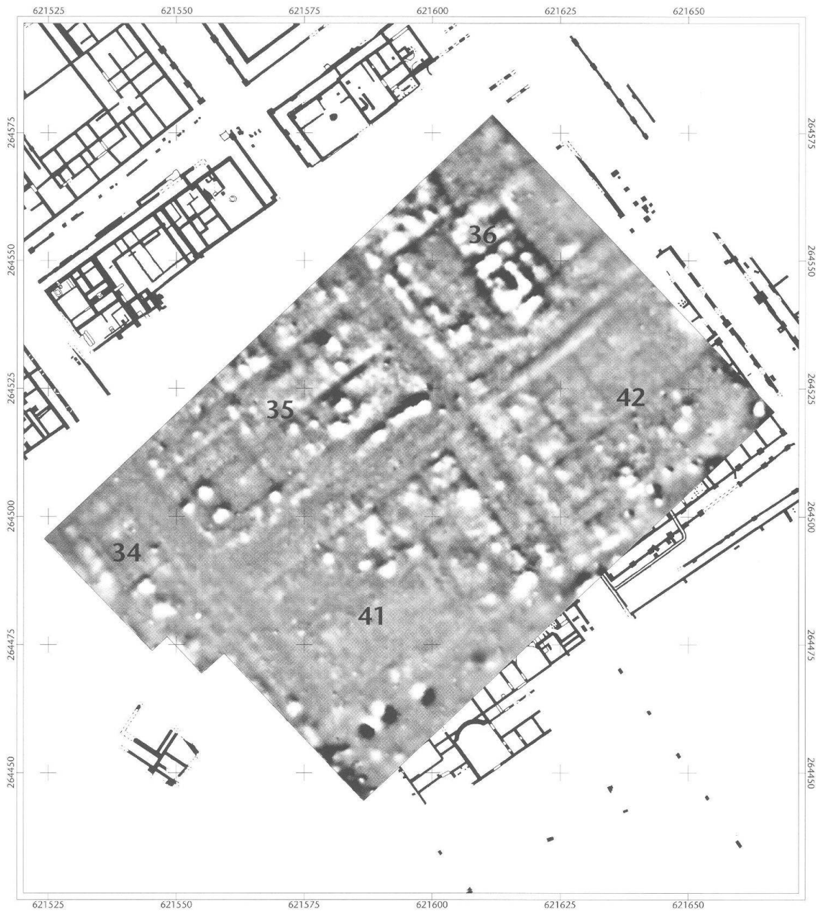
Abb. 5: Augst, insulae 34–36 und 40–42. Resultate der Magnetikmessungen . Einzelne Mauern sind gut sichtbar. Auf Grund der zum Teil sehr unterschiedlichen Signale lassen sich sogar Hinweise auf das Baumaterial gewinnen. Während vermutlich meist Kalkstein benutzt wurde, muss an einzelnen Stellen mit Backsteinen/Lehmziegelwänden gerechnet werden. Dynamik: -19 bis +19 nT/m. M. 1:1000.
