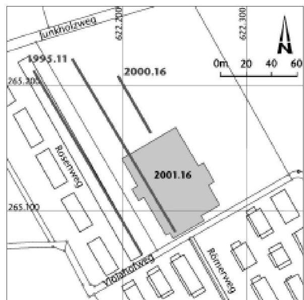
Abb. 7: Kaiseraugst AG, Konsortium «Kaisergarten», Überbauung 1. Etappe, Violahofweg (Baubegleitung 2001.16). Situation der Baugrube. M. ca. 1:3000.
