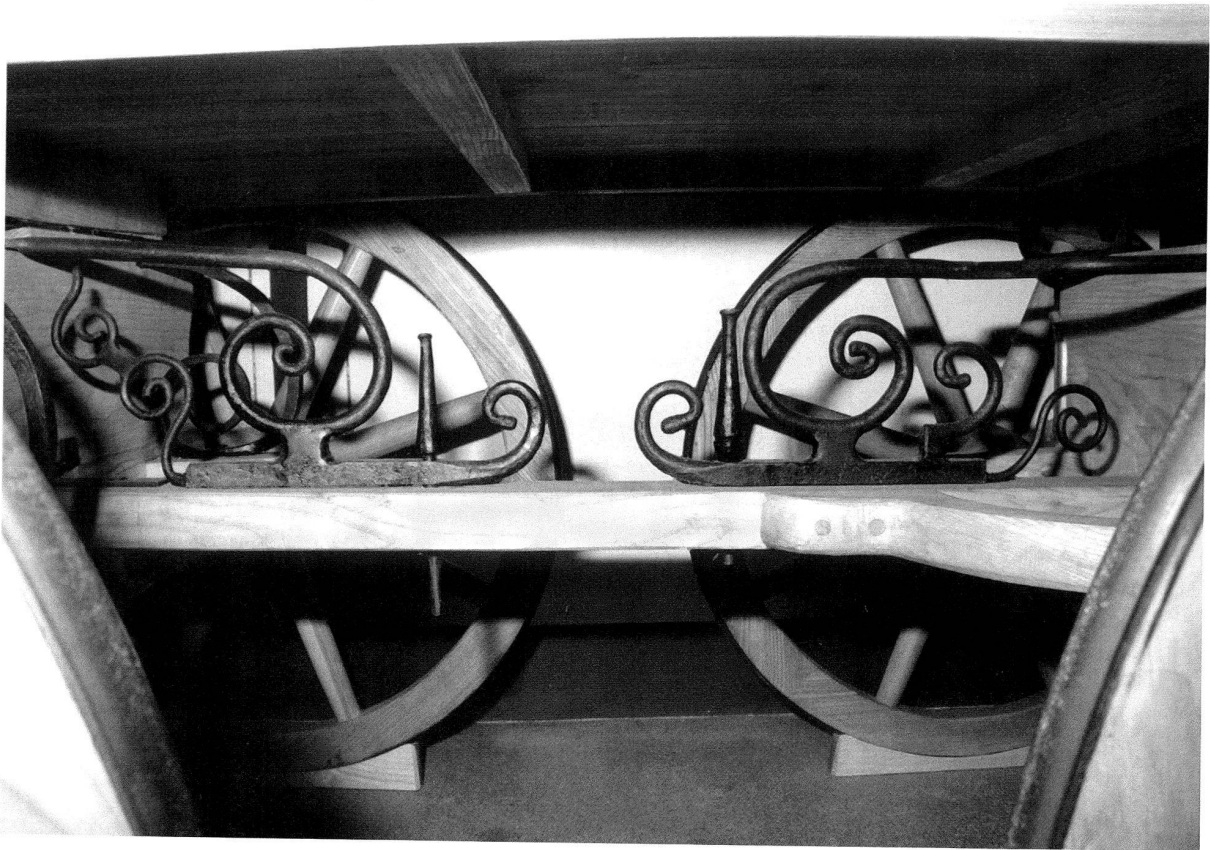
Abb. 24: Wagen-Rekonstruktion im Römerhaus in Augst. Sämtliche Eisenteile sind nach dem Wagengrab von Kozármisleny in Ungarn von Matthias Reinauer nachgeschmiedet worden.
