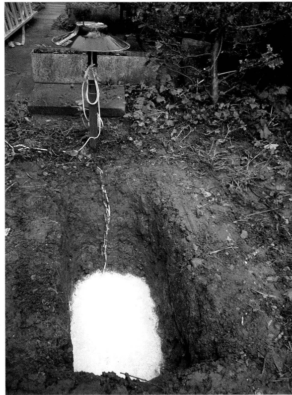
Abb. 31: Experimentelle Archäologie im Rahmen des Projekts «römische Kalkmörtel»: Geöffnete Kalksumpfgarbe im lehmigen Boden (um den Kalk gegen Witterungseinflüsse zu schützen, ist die Grube normalerweise mit Brettern und Erde gedeckt). Der Sumpfkalk wurde frisch mit Wasser überdeckt und ungerührt. Feuchtigkeit und Temperatur werden an verschiedenen Stellen in der Luft, in der Grube, im Boden und im Kalk gemessen und mit einem Computer aufgezeichnet. Das Produkt, experimentell hergestellter Sumpfkalk, soll später mit antiken Mörteln analytisch verglichen werden.
