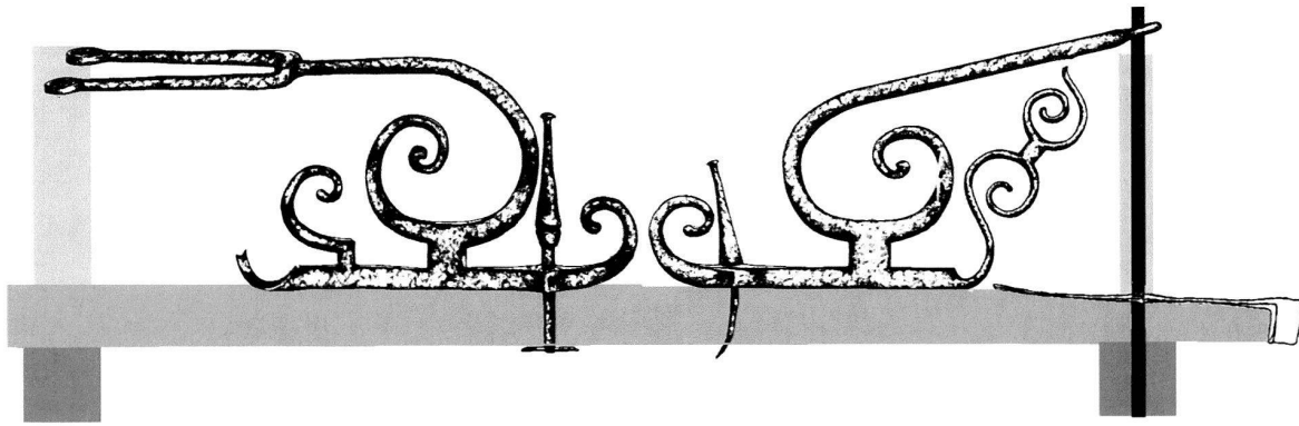
Abb. 11: Die Langfuhrbeschläge des Wagens von Kozármisleny liefern ein Mass für die Länge der Langfuhr bzw. für den Abstand der Achsen voneinander.
