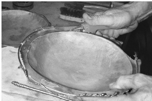
Abb. 55: Kaiseraugst, Augusta Raurica, Silberschatz. Der im Galvanobad gefertigte Kupferhohling einer Kalottenschalen-Kopie wird zugeschnitten (Bild), bevor er mit dem Galvanoteil der Schalen-Unterseite verlötet, poliert und anschliessend versilbert wird (Abb. 56).
