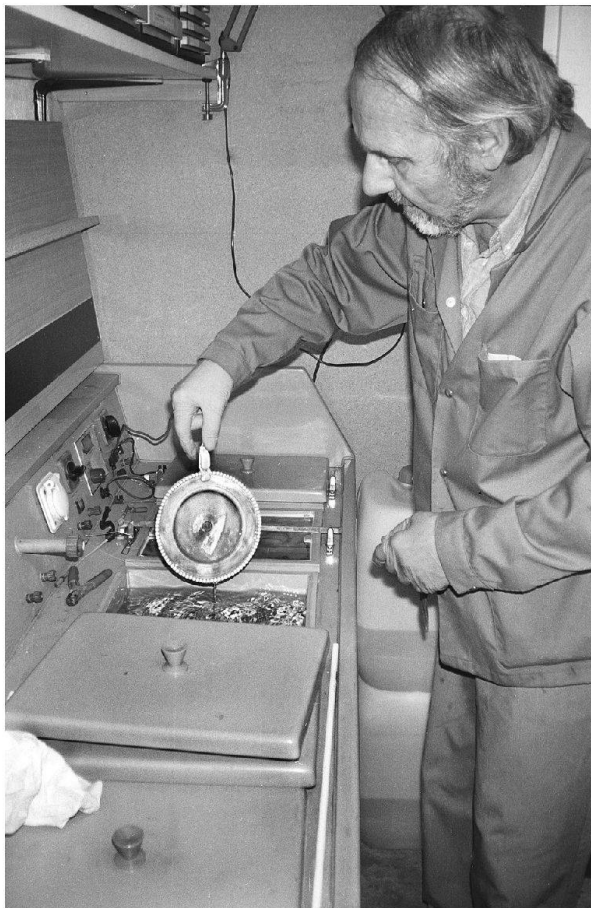
Abb. 56: Kaiseraugst, Augusta Raurica, Silberschatz. Die Galvanokopie eines Tellers mit Horizontalrand wird aus dem Vorversilberungsbad herausgenommen.
