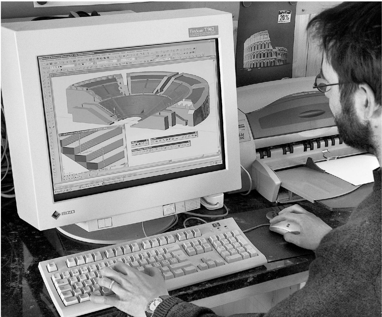
Abb. 25: Augst, Theatersanierung (Grabung 2003.55). Rekonstruktion der Sitzstufen im ersten Rang. Planung und Visualisierung der Sitzstufenrekonstruktion im zweiten Rang mit Hilfe des Computerprogramms Autodesk Architectural Desktop 3.3.
