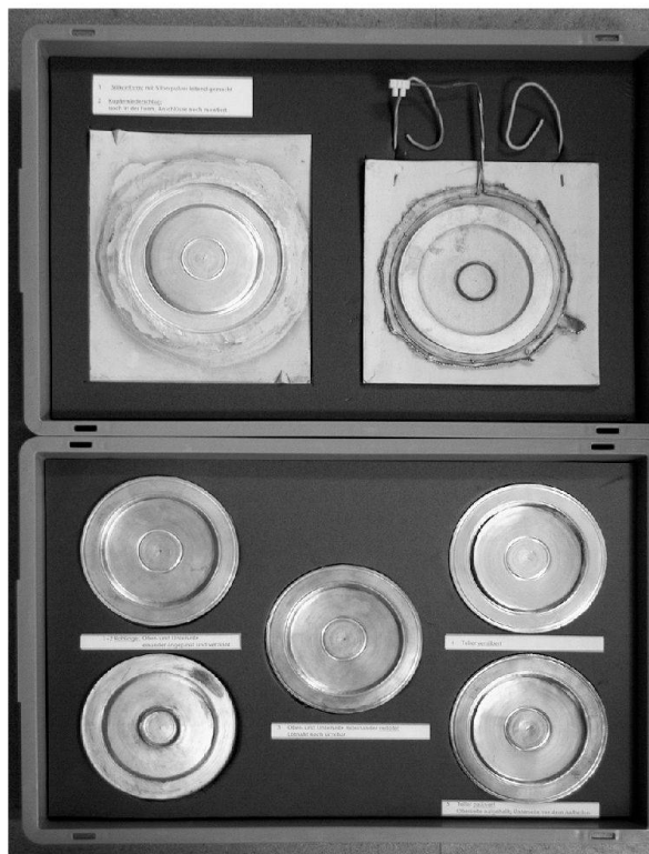
Abb. 50: Augst, Augusta Raurica. Für Vermittlungszwecke hergestellter Schritt-für-Schritt-Ablauf der Galvanokopienherstellung mit Dokumentationsstücken der einzelnen Arbeitsabläufe.
