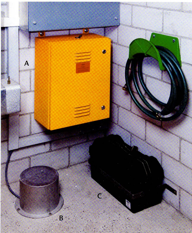
Abb. 16: Eines der im Gebiet von Augusta Raurica fest installierten seismischen Messinstrumente. Das kleine Gerät in einem Schutzkasten ist in der Kellerwand einer Scheune in der römischen Oberstadt (Augst/BL, Insula 9) verankert und permanent mit der Zentrale des Schweizer Erdbebendienstes an der ETH in Zürich verbunden. Ein weiteres Gerät steht in einem Keller in der antiken Unterstadt (Kaiseraugst/AG, Region 16D).
