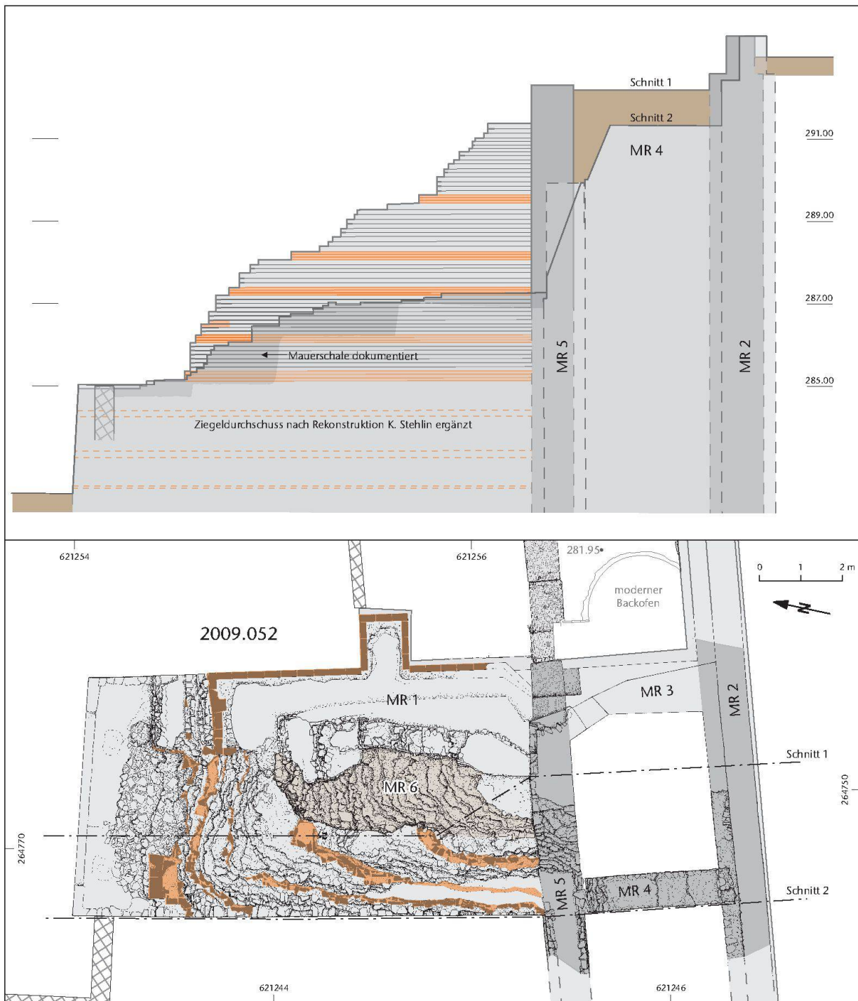
Abb. 15: Augst BL, Stützpfiler Schönbühl (Grabung 2009.052). Aufsicht und Schnittebenen durch den Stützpfiler. Die Ziegeldurchschüsse im Mauerwerk sind dunkelrot/orange hervorgehoben. M. 1:125.
