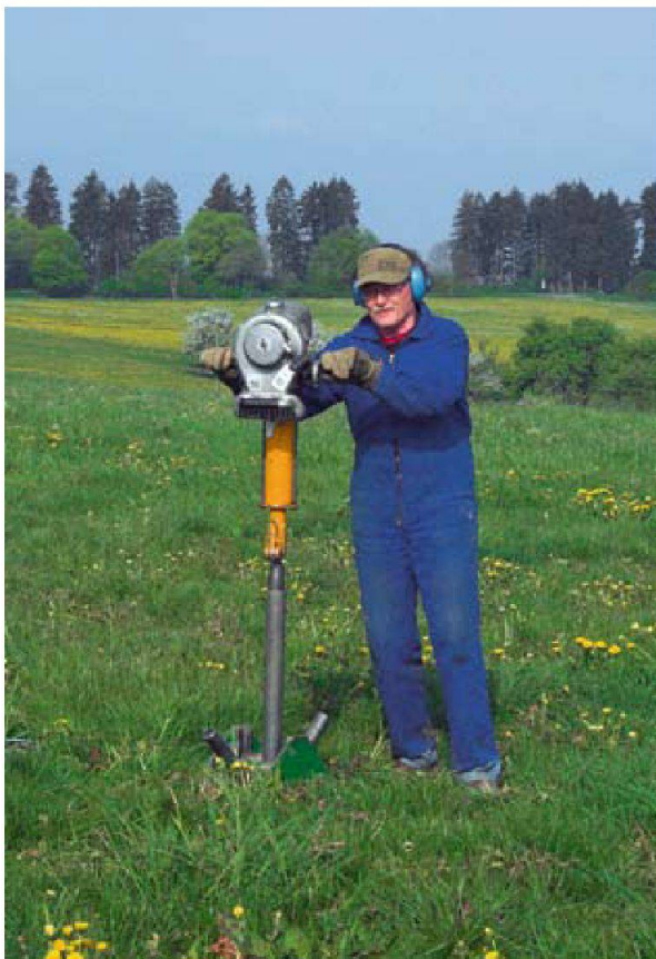
Abb. 5: Leichtes Kleinrammkern-Bohrgerät. Mit dem Einsatz eines solchen tragbaren Geräts entsteht kaum Flurschaden, wenn mitten in einem Acker eine Proben-Bohrung vorgenommen wird.
